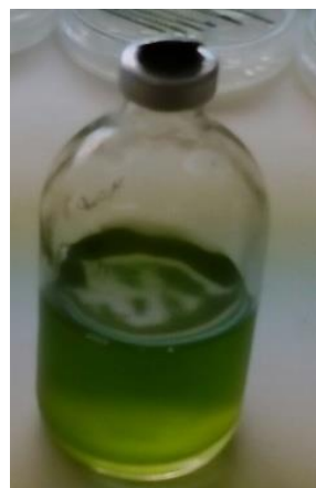
Εικόνα 2.4. Μπουκάλι των 100 mL που χρησιμοποιήθηκε ως βιοαντιδραστήρας κλεισμένο ερμητικά με septum.
