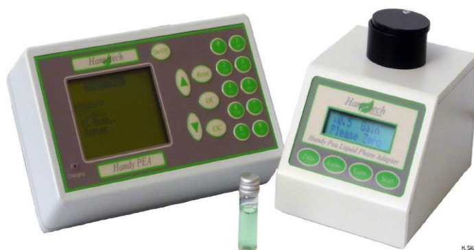
Εικόνα 19. Η συσκευή Handy PEA για τον προσδιορισμό του επαγωγικού φθορισμού σε κύτταρα υγρής καλλιέργειας.
