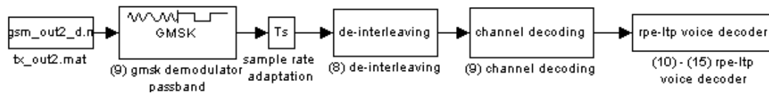
Σχήμα 3.8: Το μοντέλο δέκτη full rate καναλιού
