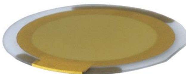
Εικόνα 8: κρύσταλλοι χαλαζία για Q-sense βιοισθητήρα
