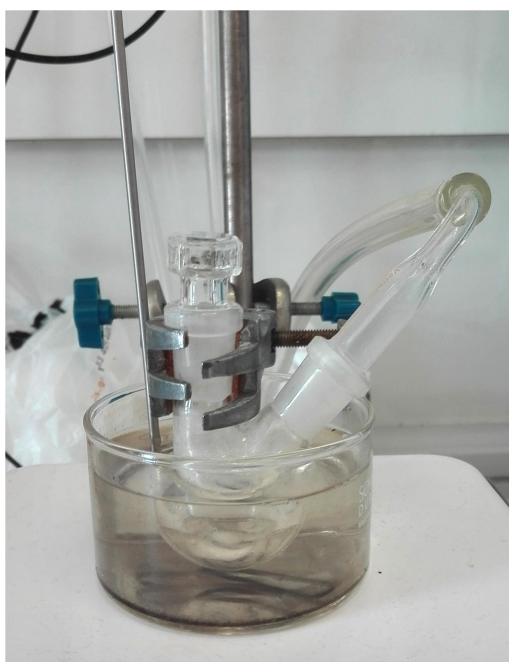
Σχήμα 4.3.3: Θέρμανση με βύθιση της Schlenk φιάλης σε ελαιόλουτρο πάνω σε θερμαντική πλάκα.
