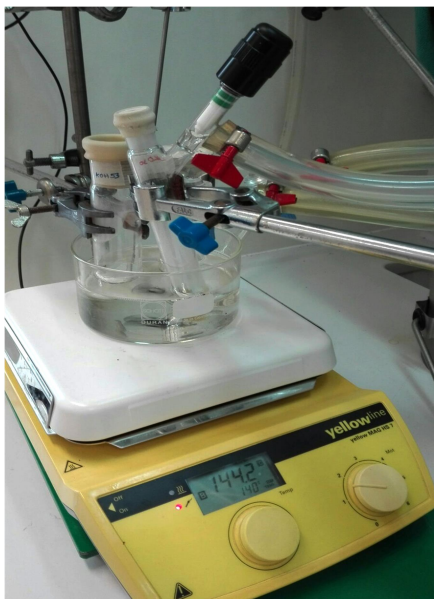
Εικόνα 4.4.3α: Πειραματική διάταξη για τον (ROP) πολυμερισμό
