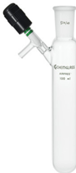
Εικόνα 4.4.3β: Schlenk φιάλη των 100ml που λαμβάνει χώρα η αντίδραση του πολυμερισμού
