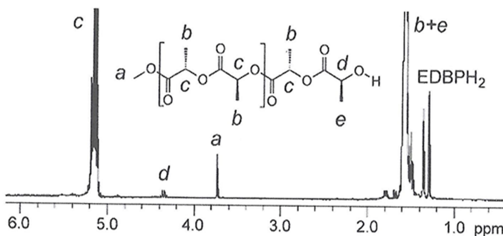
Σχήμα 4.5.2β : Φάσμα ^1\text{H} NMR του PLA με εκκινητή \text{MeOH}_{[10]} .
