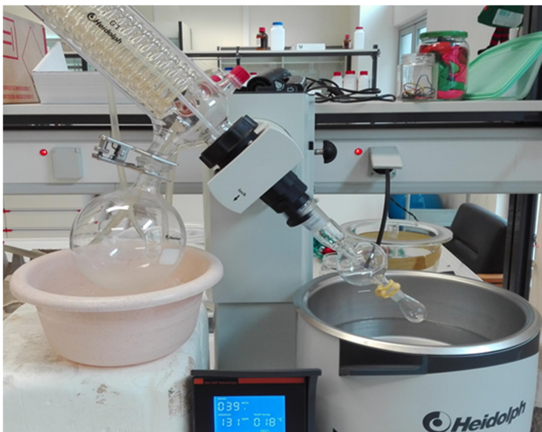
Εικόνα 4.4.3ε: Πειραματική διάταξη εξάτμισης υπό κενό
