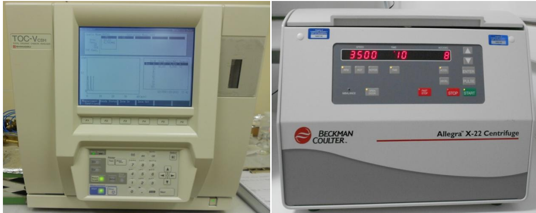
Εικόνα 3.8: α) Αναλυτής Ολικού Οργανικού Άνθρακα, β) Φυγόκεντρος της Beckman Coulter.
