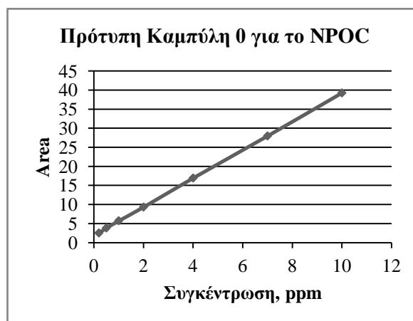
Σχήμα 3.3: Καμπύλη βαθμονόμησης για το μη πτητικό οργανικό άνθρακα.
