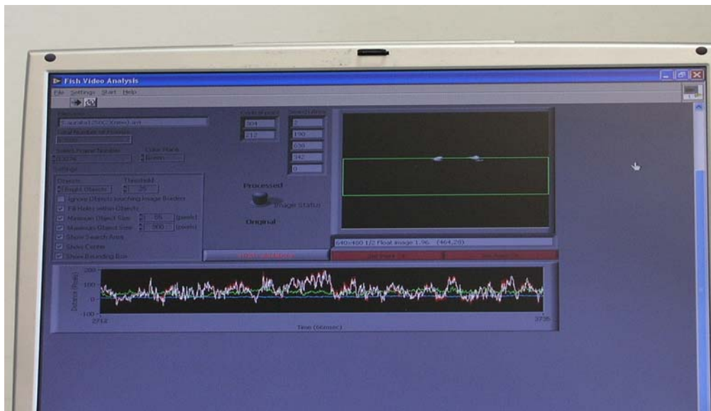
Εικόνα 2.8 : User interface λογισμικού ανάλυσης. Δεξιά διακρίνεται η περιοχή εντοπισμού των ψαριών. Κάτω γραφική αναπαράσταση της μεταβολής της μέσης απόστασης του συνόλου των ψαριών κατά τη διάρκεια της ανάλυσης.
