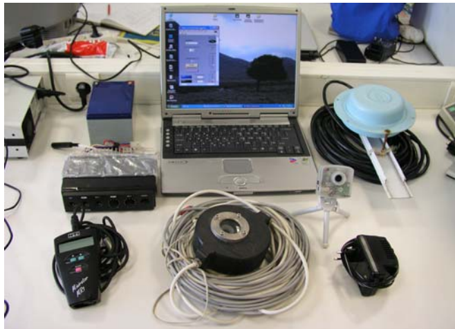
Εικόνα 2.7 : Φορητό σύστημα καταγραφής ήχου και εικόνας. Μπροστά στον υπολογιστή η κάμερα –πάνω σε τρίποδο- και μέσα στο αδιάβροχο κουτί.
