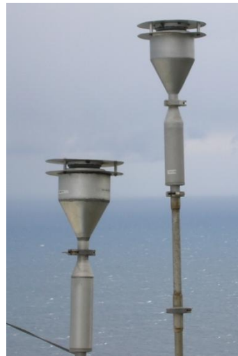
Εικόνα 3.3: Σχηματική απεικόνιση του σημείου εισόδου των διαχωριστών
