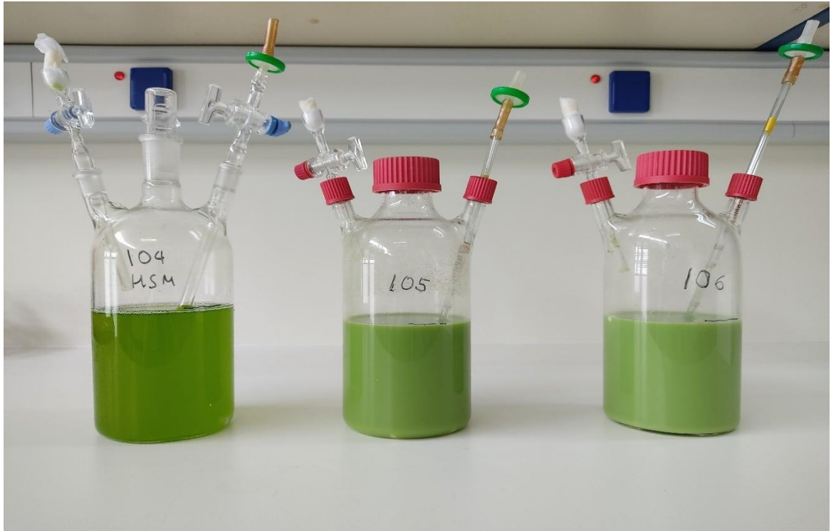
Εικόνα 2.3: Καλλιέργειες Chlorella sp σε πρωτογενή απόβλητα τυρογάλακτος, σε φωτοβιοαντιδραστήρα 1 L.
