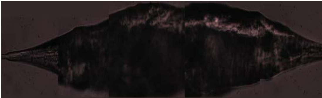
Εικόνα 3.13 – Taper διαμέτρου 25μm με επίστρωση πάχους 184μm
