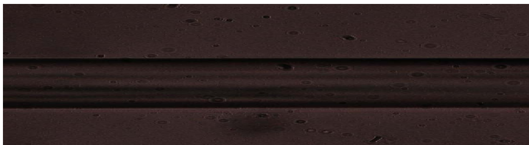
Εικόνα 3.9 – Καθαρό taper διαμέτρου 25μm χωρίς επίστρωση
