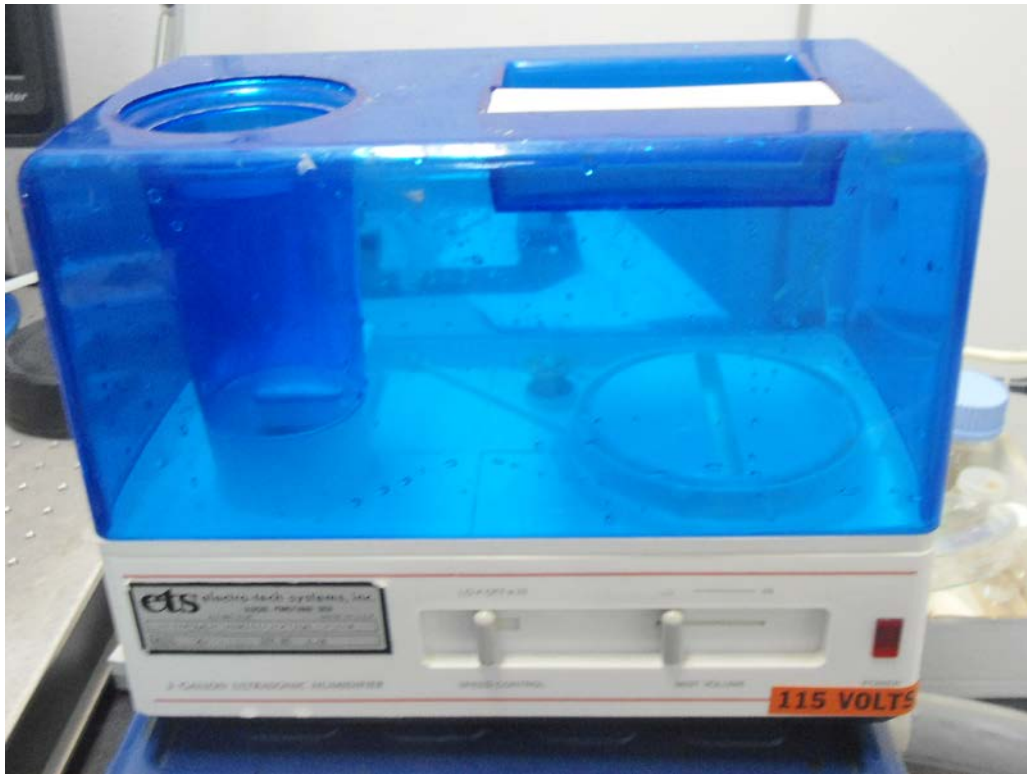
Εικόνα 3.4 – Υγραντήρας για την δημιουργία υδρατμών
