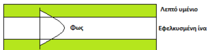
Εικόνα 3.1 – Απλός αισθητήρας με τη χρήση εκλεπτυσμένης ίνας με επίστρωση.
