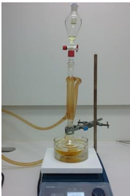
Εικόνα 4.3. Πειραματική διάταξη, όπου στη διαχωριστική χοάνη υπάρχει το μίγμα του \text{HNO}_3 και του π. \text{H}_2\text{SO}_4 .
