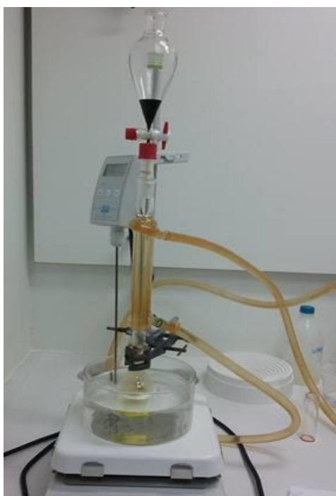
Εικόνα 4.2. Πειραματική διάταξη, όπου στη διαχωριστική χοάνη διακρίνεται το κόκκινο χρώμα του μίγματος 9 – fluorene – 4 carboxylic acid και π. \text{H}_2\text{SO}_4 .
