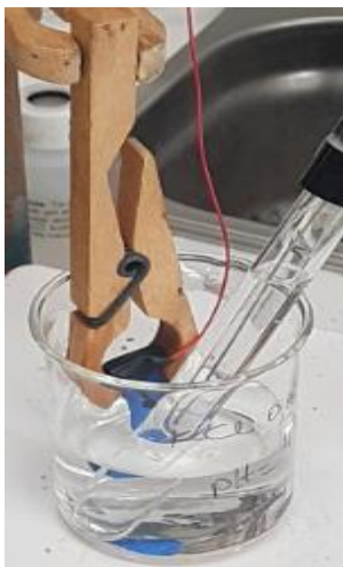
Εικόνα 14: Πειραματική διάταξη για την εφαρμογή ηλεκτροδίου στην θέση το BNC καλωδίου.
