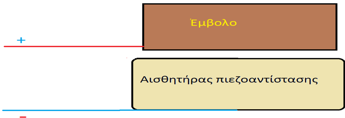
Εικόνα 12: Το κύκλωμα ανοίγει όταν ανασηκώνεται το έμβολο.
