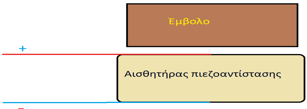
Εικόνα 13: Το κύκλωμα είναι συνέχεια κλειστό.
