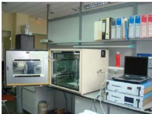
Σχήμα 3.17 Φωτοκαταλυτικός αντιδραστήρας (περιβαλλοντικός κυβικός θάλαμος) με 10 λάμπες UV στους γύρω τοίχους και 2 ανεμιστήρες για σταθερές συνθήκες θερμοκρασίας δωματίου. Τα φωτοκαταλυτικά \text{TiO}_2 υλικά τοποθετήθηκαν μέσα στο κελί, το οποίο γέμιζε με \text{NO} από τη σωλήνα εισόδου. Η σωλήνα εξόδου χρησιμοποιήθηκε για καταγραφή της συγκέντρωσης των \text{NO}_x με χρήση ενός αναλυτή \text{NO}_x
