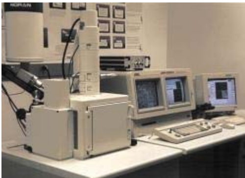
Σχήμα 3.11 Τυπικό SEM, το οποίο αποτελείται από: κανόνι ηλεκτρονίων, θάλαμο δείγματος, ανιχνευτή EDS, κονσόλα ηλεκτρονικών και οθόνες για την οπτική απεικόνιση
