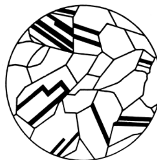
Εικόνα 2. 12. Γραμμική αναπαράσταση της μικροδομής μετάλλου μετά από σφυρηλάτηση και ανόπτωση.
