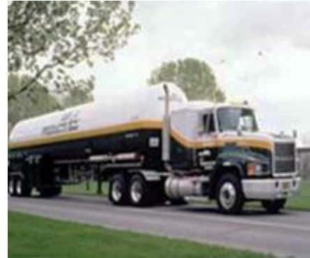
Εικόνα 1.5 Μεταφορά υδρογόνου με κρυογονικό βυτιοφόρο (πηγή: U.S. Department of Energy Hydrogen Program)
