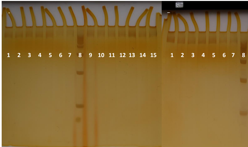
Εικόνα 36 Gel πολυακρυλαμίδης όπου έτρεξαν τα προϊόντα της πέψης του γενετικού υλικού των βακτηριοφάγων με 3 διαφορετικά ένζυμα. A: 1 - 7 BamHI όπου 1 – St1, 2- St2, 3 – G2, 4 – G3, 5 – Grn1, 6 – Prt1, 7 – SelM και 9 – 14 HindIII, όπου 9 - St1, 10 - St2, 11 – G2, 12 – G3, 13 – Grn1, 14 – Prt1, 15 – SelM και 8 – γενωμική κλίμακα 100 – 1000bp, B: 1-7 HaeIII όπου 1 – St1, 2- St2, 3 – G2, 4 – G3, 5 – Grn1, 6 – Prt1, 7 – SelM, 8 - γενωμική κλίμακα 100 – 1000bp.
