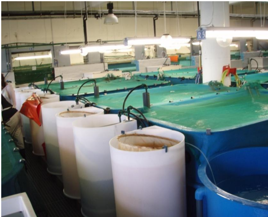
Εικόνα 9. Ορθογώνιες δεξαμενές (n=4) των 5 m 3 όπου φιλοξένησαν τα υπό μελέτη άτομα συνδεδεμένες με δεξαμενές-συλλέκτες των αυγών. Κάθε δεξαμενή περιείχε ένα θηλυκό και ένα αρσενικό κρανιό χωρίς να γίνεται ανταλλαγή συντρόφων.
