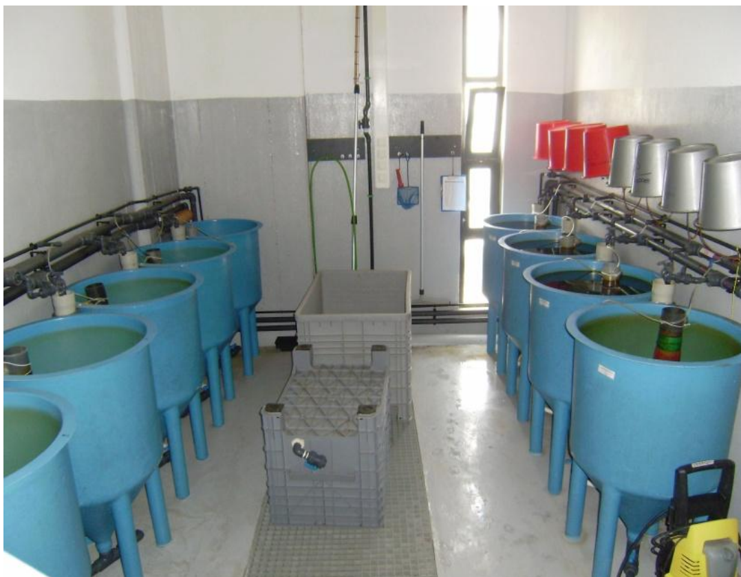
Εικόνα 11. Κυκλικές δεξαμενές χωρητικότητας 300 l όπου επωάζουν τα αυγά (επωαστήρες).
