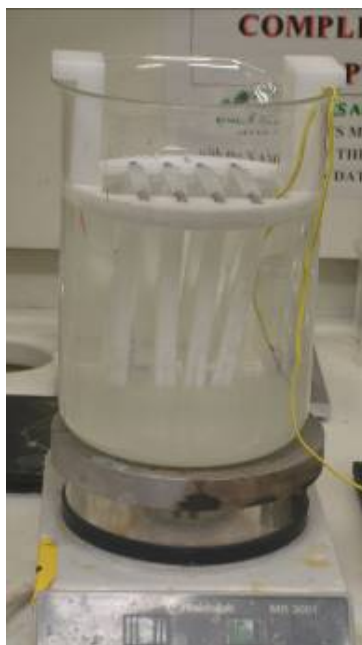
Εικόνα 6.2.1: Φωτογραφία δοχείου με υποδοχείς από τefλόν για την χημική ανάπτυξη νανοράβδων ZnO.
