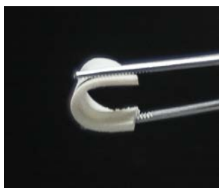
Εικόνα 5.1: Φωτογραφία δείγματος ZnO/PDMS με περιεκτικότητα 10% w/w σε ZnO.
