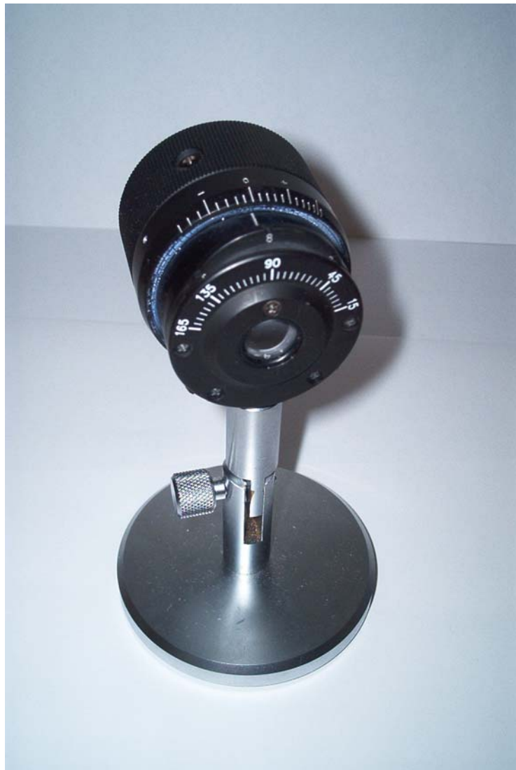
Εικόνα 4. 4: Φωτογραφία από το διαμορφωμένο μοντέλο οφθαλμού όπου απεικονίζονται οι ρυθμίσεις της διαμέτρου της ίριδας όπως και της διόρθωσης της μυωπίας ή υπερμετρωπίας αντίστοιχα
