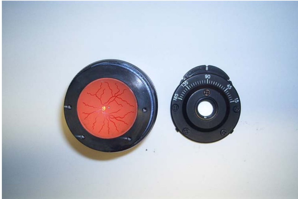
Εικόνα 4. 5: Φωτογραφία του εσωτερικού του μοντέλου του οφθαλμού όπου απεικονίζεται το τοίχωμα του τεχνητού αμφιβληστροειδή και το οπτικό σύστημα
