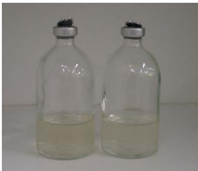
Εικόνα 16. Μπουκαλάκια των 100 mL, ερμητικά κλειστά με septa, στα οποία πραγματοποιήθηκαν τα πειράματα
