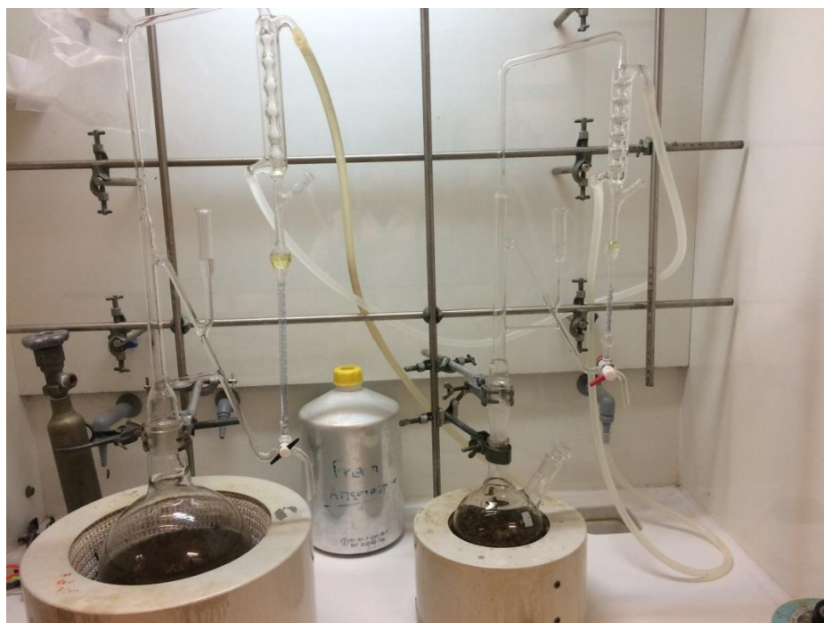
Εικόνα 7: Απόσταξη αιθέριου ελαίου ρίγανης μέσω δύο αποστακτικών συσκευών τύπου Clevenger.
