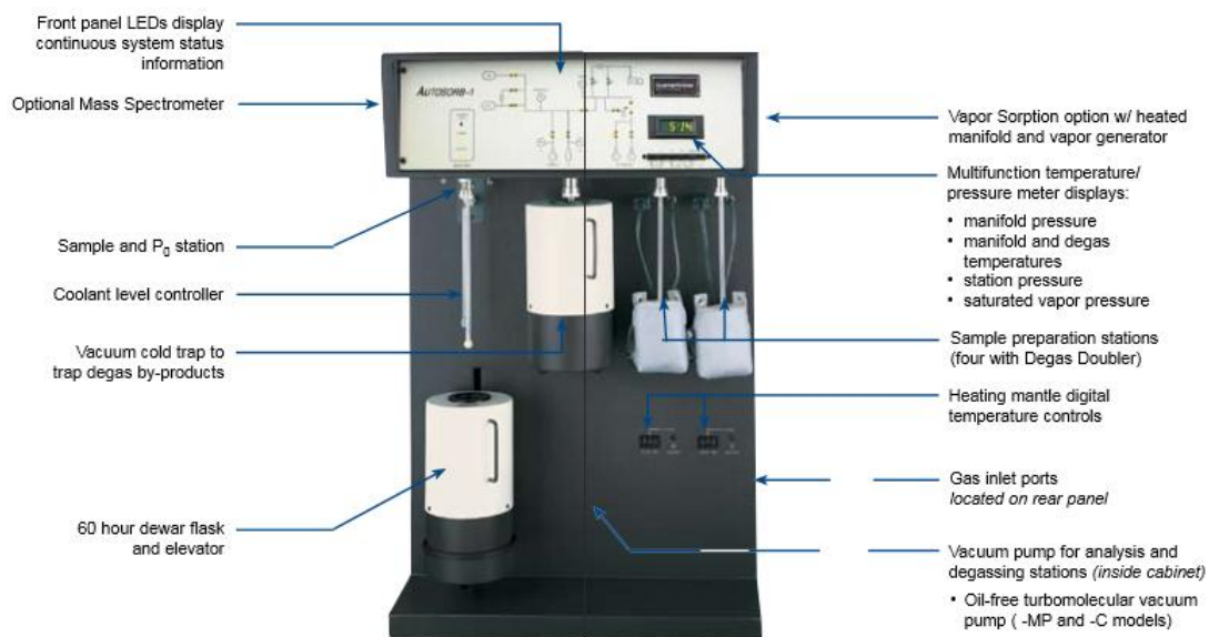
Σημα 12: Τα επιμέρους μέρη του ποροσίμετρου Autosorb S – 1 της Quantachrome.
