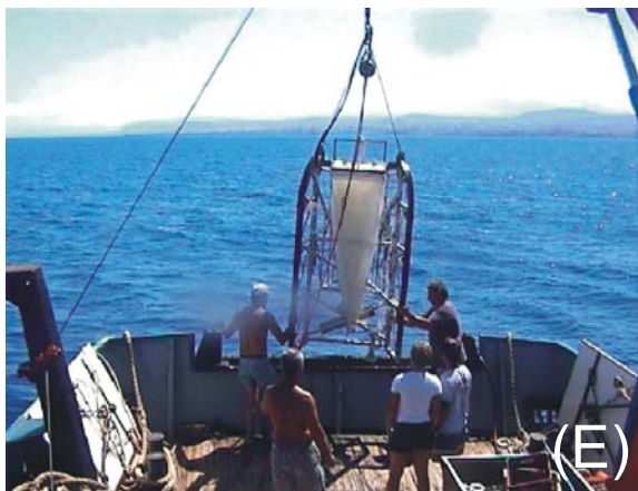
Εικόνα 2.6. Επιμέρους εξαρτήματα του δειγματολήπτη TTSS2. (Α) Ηλεκτρομηχανικός μηχανισμός ανοίγματος-κλεισίματος της εισόδου των δικτύων, θάλαμος πίεσης, (Β) Έγχρωμη βιντεοκάμερα, θάλαμος πίεσης, πλαγκτονικά δίκτυα, (Γ) Δίκτυα συλλογής, οδόμετρο, (Δ) «Γραντί μολυβιού», μεταλλικοί βραχίονες, μεταλλική ράβδος, (Ε) Ανέλκυση του δειγματολήπτη TTSS2 χωρίς «γραντί» στο σκάφος υποστήριξης «ΦΙΛΙΑ», (Ζ) Συλλογή δειγμάτων μετά την ανέλκυση του δειγματολήπτη TTSS2 στο «ΦΙΛΙΑ».
