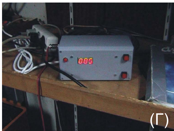
Εικόνα 2.7. Εξαρτήματα υποστήριξης του δειγματολήπτη TTSS2 από το σκάφος επιφανείας. (Α) Σύστημα προβολής και αποθήκευσης ψηφιακής εικόνας (Β) Κονσόλα ελέγχου ψηφιακής εικόνας (Γ) Μηχανισμός ηλεκτρονικής καταγραφής των περιστροφών του οδομέτρου.
