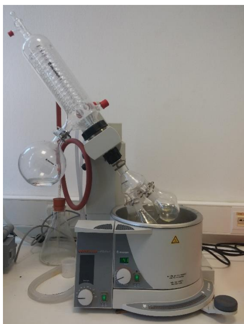
Εικόνα 15: Ο Rotary evaporator που χρησιμοποιήθηκε για την συμπύκνωση των διαλυμάτων των καρτενοειδών.
