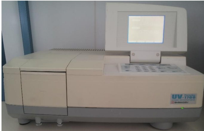
Εικόνα 17: Το φασματοφωτόμετρο στο οποίο πραγματοποιήθηκε η μέτρηση της απορρόφησης των διαλυμάτων των καρτενοειδών.
