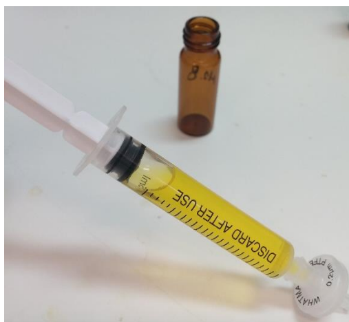
Εικόνα 16: Φιλτράρισμα του τελικού διαλύματος των καροτενοειδών με φίλτρο σύριγγας πόρου 0,2 μm.
