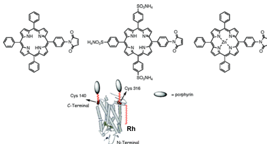
Σχήμα 1.39 Πορφυρινικά παράγωγα με ομάδα μαλεϊμιδίου που έχουν χρησιμοποιηθεί για in vitro σήμανση ροδοφίνης (Rh) μέσω θειοαιθερικού δεσμού μεταξύ του μαλεϊμιδίου της πορφυρίνης και των κυστεϊνών Cys140 και Cys316 (χημική σήμανση). 95
