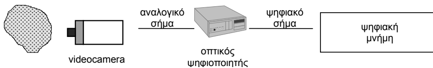
Σχήμα 5 : Σχηματική παράσταση μετατροπής οπτικού σήματος σε ψηφιακή εικόνα.
