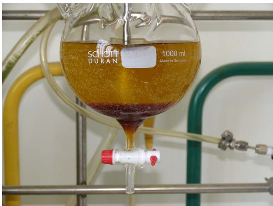
Εικόνα 5. Ο εστέρας και η συμπαραγόμενη γλυκερόλη όπως διαχωρίζονται στο πρώτο στάδιο της αντίδρασης
