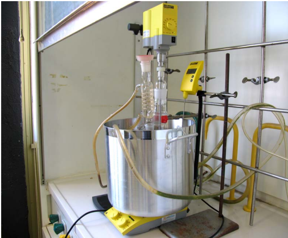
Εικόνα 1. Ο αντίδραστήρας που χρησιμοποιήθηκε σε συνδιασμό με το υδατόλουτρο που θερμοστατούταν με το σύστημα ανάδευσης θερμαντικής πλάκας
