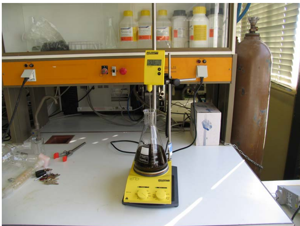
Εικόνα 2. Η θέρμανση των ελαίων για απομάκρυνση της υγρασίας
